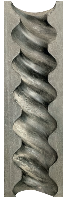
Stator Kaleta z wytrąconym woskiem Kaleta Stator with precipitated wax Kaleta Stator mit abgeschiedenem Wachs Калета Статор с осажденным воском
